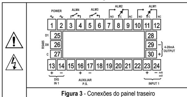
Figura 3 - Conexões do painel traseiro
